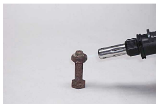
Løser mindre bolter ved hjelp av flammebrenneren
