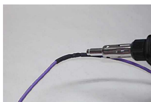
Krymping av krympestrømper med varmluft (F. eks. Thermoflux)
