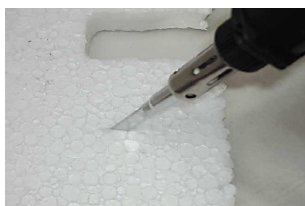
Meget nøyaktig skjæring med varmekniv i isopor, nylonnett, canvas osv.
