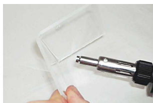
Forming av plast ved hjelp av varmluft
