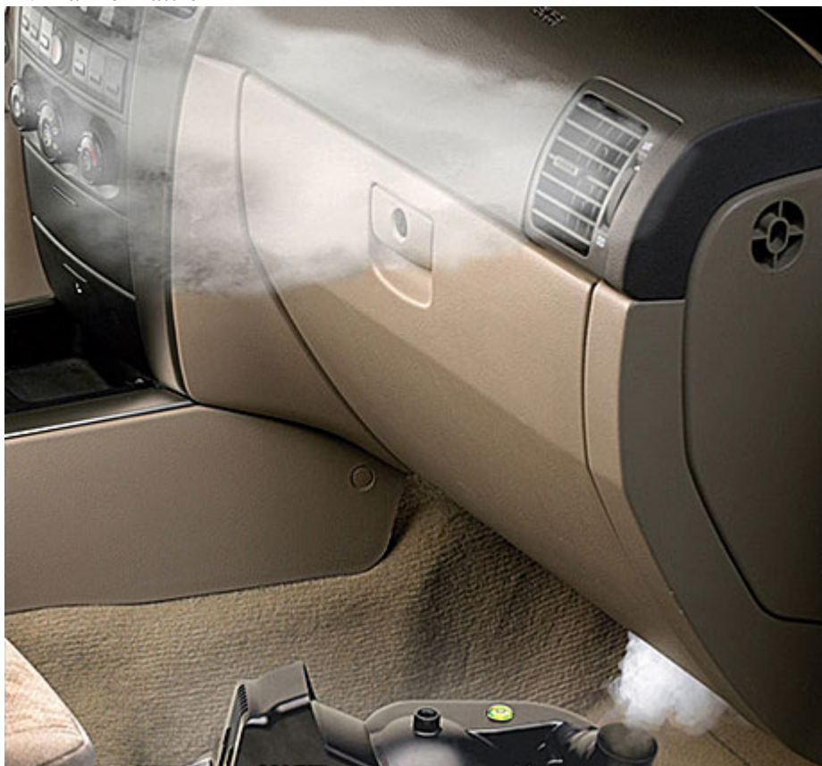
SKAL FJERNE BAKTERIER: Det finnes mange metoder for å fjerne bakteier og mugg i klimaanlegg. Her er en av dem, som bruker høyfrekvent lyd til å forstøve kjemikalier. Foto: Mist
