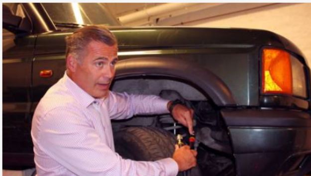
Terje Tjelland i Relekta AS med spesialutstyret som bytter girolje helt. Slangene festes foran, maskinen både rengjør og skifter. Mange verksteder nøyer seg med å tappe bunnpannen. (Foto: Newswire)
