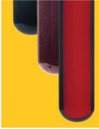
Oljeprøver i reagensrør. Svart: Gammel automatolje. Mørk rød: Slik oljen ser ut etter et mangelfullt oljeskift. Rød: Slik automatoljen skal se ut etter et fullverdig oljeskift. (Foto: Relekta AS)
