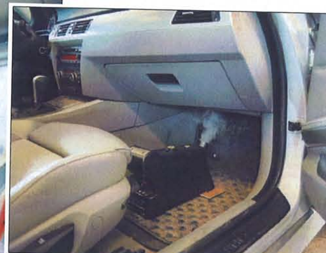
RØYKLEGGER BILEN: Dampen, med mikroskopiske dråper av bakteriedrepende middel, dras gjennom hele ventilasjonsanlegget og fyller hele kupeen i bilen.
