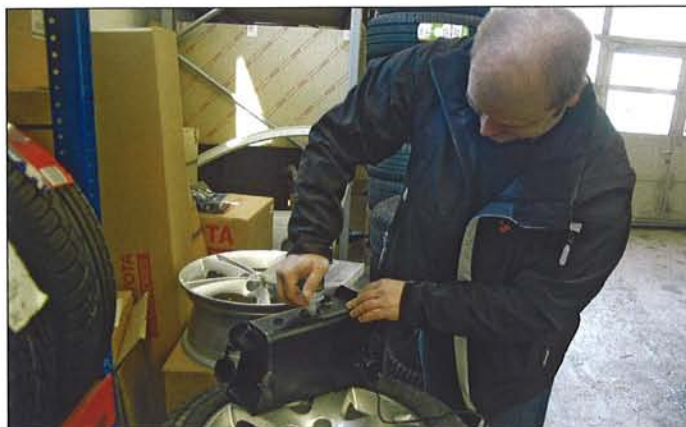
Den spesielle kjemiske væsken presses inn i forstøverapparatet. En liten flaske skal være nok for et halvt til ett år.
